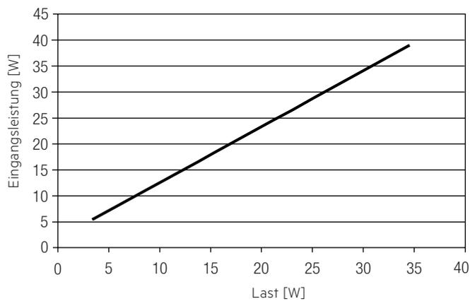
**4.6 Maximale Belastung von Leitungsschutzautomaten bezogen auf den Einschaltstrom**
