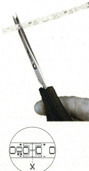
Den flexiblen LED-Streifen auf die gewünschte Länge kürzen. Die minimale Anschlusslänge beträgt 0,5 m. Beim Trennen in der Mitte des Löt pads schneiden. Scharfes Werkzeug wie z. B. Elektroniker-Seitenschneider oder Schere verwenden.
