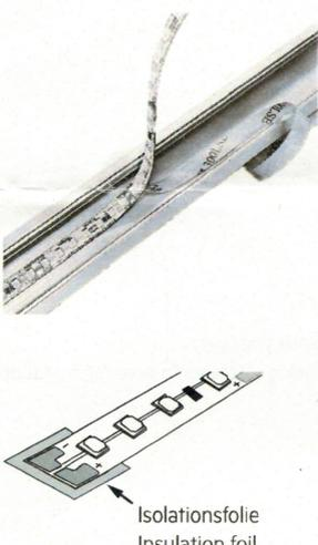
Das Tape auf einen festen, wärmeleitfähigen Untergrund kleben z.B. ein Aluminium-Profil. Die Fläche muss staub- und fettfrei sein. Ein minimaler Biegeradius von 2 cm muss eingehalten werden. Der LED-Streifen darf nicht auf normal entflammaren Materialien wie z.B. Holz montiert werden. Den LED-Streifen vor Staub und Schmutz schützen. Einen Isolationsaufkleber unter den Enden des LED-Streifens anbringen.
